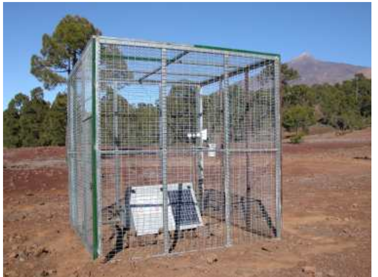
Estación geoquímica TFE04 para la medida en continuo del flujo difuso de dióxido de carbono y sulfuro de hidrógeno, Icod de Los Vinos, Tenerife.
